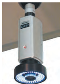
QVP (Quick Vision Probe - Kamerová snímací sonda)
