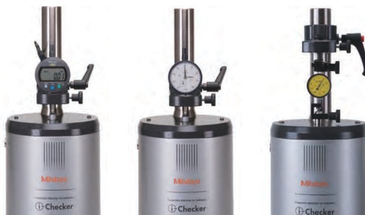
Kontrola číselníkových páčkových úchylkoměrů s volitelným příslušenstvím
