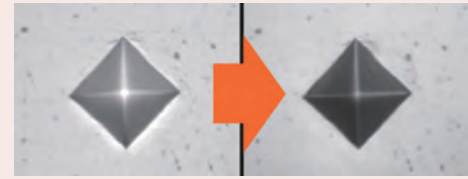
Pozorovaný obraz vtisku (50X). Snížení rozptylu světla kolem vtisku.
