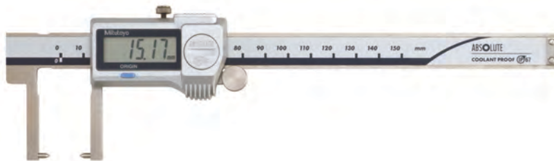
573-652-20 Provedení se špičatými hroty
