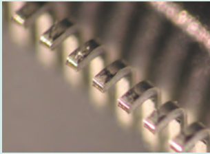
Příklad měření: Výška nožiček na QFP obalu
