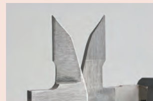
Měřicí čelisti osazené tvrdokovem
