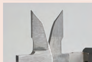
Měřicí čelisti osazené tvrdokovem
